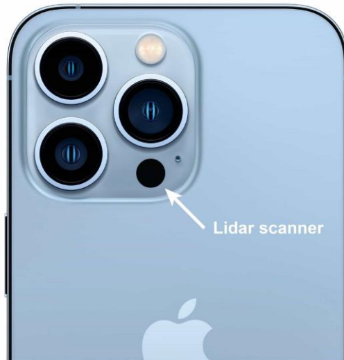
Σχήμα 11 - Apple iPhone με ενσωματωμένο αισθητήρα λέιζερ 17
