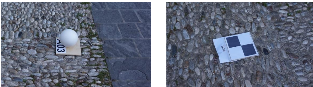
Σχήμα 4 - Τεχνητοί στόχοι σφαιρικοί (αριστερά) και τύπου σκακιέρας (δεξιά)
