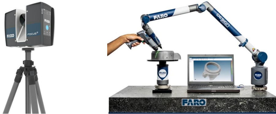
Σχήμα 8 – Σαρωτής λέιζερ χωρίς φυσική επαφή (αριστερά) και με φυσική επαφή (δεξιά) 4
