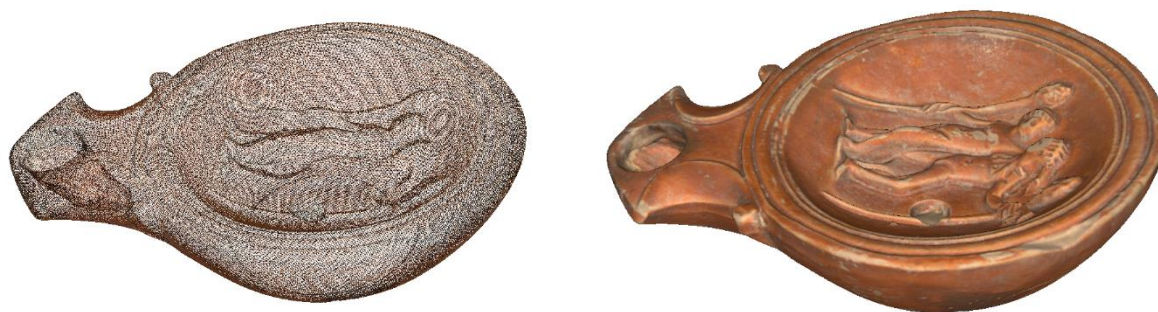
Σχήμα 7 – Αρχαίο λυχνάρι με πληροφωρία χρώματος, πυκνό νέφος σημείων (αριστερά) λεπτομερές τριγωνικό πλέγμα (δεξιά)
