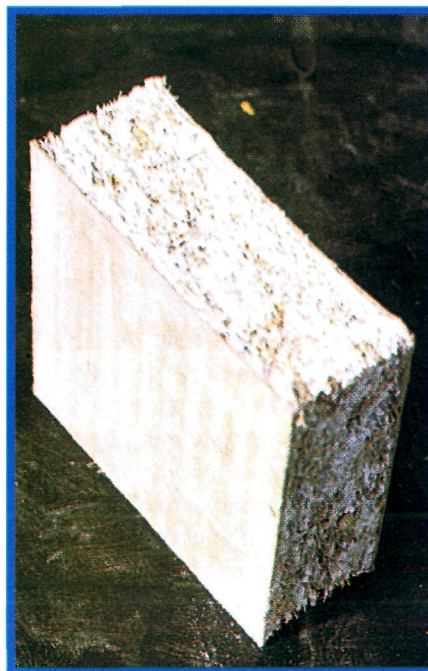
Δοκίμιο κατασκευασμένο με ψηλή πίεση από καλάμι και γύψο. Η τελική επιφάνεια είναι χαρτόνι που κόλλησε με τη μεγάλη πίεση στο δοκίμιο κατά την παραγωγή του
