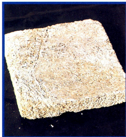
Δοκίμιο ΑΚ11 κατασκευασμένο με χαμηλή πίεση που συνδυάζει τα πλεονεκτήματα του θερμομονωτικού υλικού με αυτά της μορφοσανίδας
