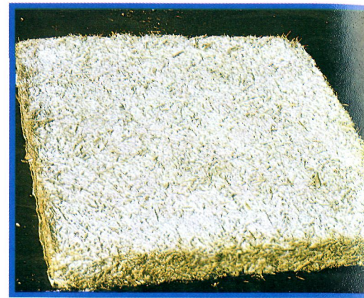
Δοκίμιο κατασκευασμένο με χαμηλή πίεση από καλάμι και γύψο
