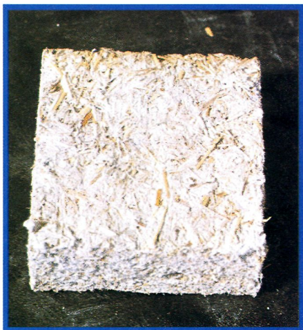
Δοκίμιο ΕΚ χρήσιμο ως θερμομονωτικό υλικό ή υλικό συσκευασίας
