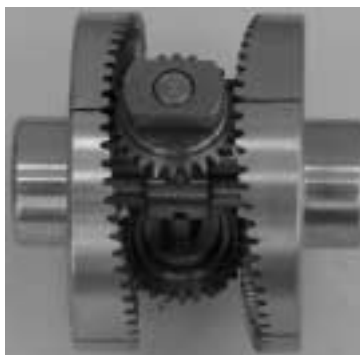
Το καινοτόμο διαφορικό ελεγχόμενης διαφοροποίησης με καμπυλοειδή γρανάζια
